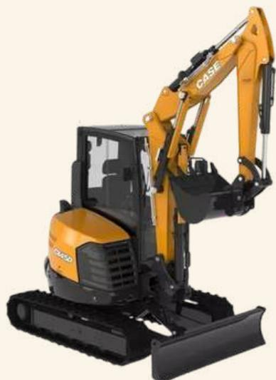
La CX45D est une mini-pelle de milieu de gamme de la série D de CASE, pesant environ 4 600-4750 kg selon version, équipée d'un moteur Kubota D1803-CR-T Stage V développant ~43,9 chevaux (= 32,3 kW). Elle offre une profondeur de fouille de 3,23 m, avec possibilité d'extension à ≈ 3,48 m via bras long.
