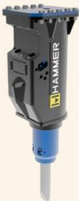
Brise-roche hydraulique pour pelles de 1,5 à 3,8 tonnes, débit requis 22-40 l/min, pression de 110 bar, fréquence de 800-2000 coups/min et puissance de frappe de 580 joules. Poids : 135 kg.
