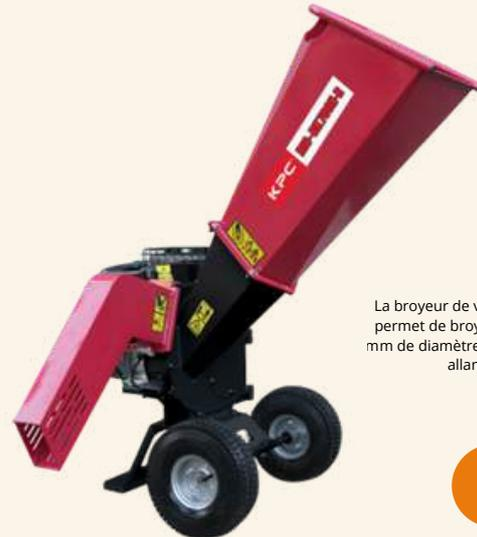
La broyeur de végétaux BK700N-R de 7 HP permet de broyer des branches jusqu'à 60 mm de diamètre avec une capacité de travail allant jusqu'à 3 m<sup>3</sup>/h.
