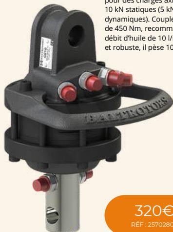
Rotation continue illimitée, conçu pour des charges axiales jusqu'à 10 kN statiques (5 kN dynamiques). Couple de rotation de 450 Nm, recommandé pour un débit d'huile de 10 l/min. Compact et robuste, il pèse 10 kg.
