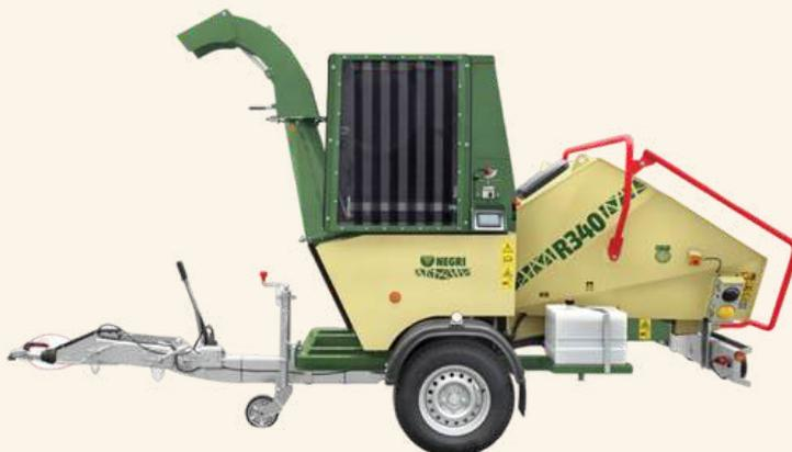
Broyeur de branches sur remorque routière, équipé d'un moteur diesel Kohler de 56 CV. Il peut broyer du bois jusqu'à 18 cm de diamètre avec une capacité de 25 à 30 m³/h. Sa goulotte orientable à 270° facilite l'évacuation des copeaux. Robuste et mobile, il est homologué pour la route, idéal pour les professionnels en déplacement.
