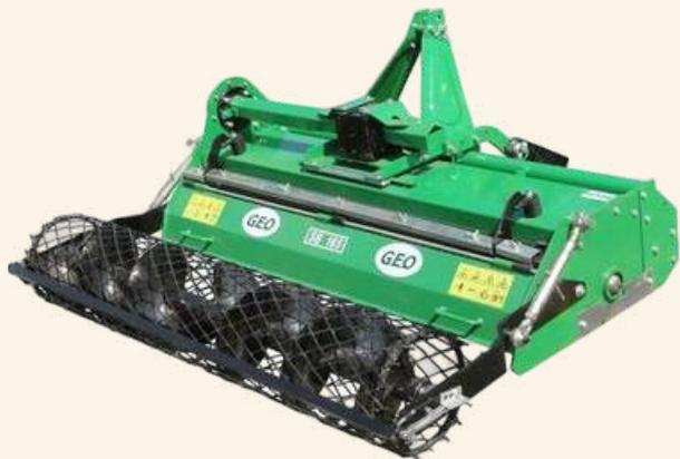
Compact, le GEO SB105 est conçu pour tracteurs de 25 à 35 CV. Avec ses 105 cm de largeur de travail, il enfouit efficacement pierres, mottes et débris, tout en nivelant le sol grâce à son rouleau grille réglable. Transmission par chaîne, 20 lames hélicoïdales sur rotor, attelage 3 points déportable. Idéal pour la préparation des sols en maraîchage, espaces verts et plantations.
