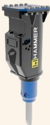
Brise-roche hydraulique pour pelles de 5 à 10 tonnes, avec un débit requis de 45-100 l/min, une pression de 160 bar, une fréquence de 500-1150 coups/min et une puissance de frappe de 1600 joules. Poids : 350 kg.
