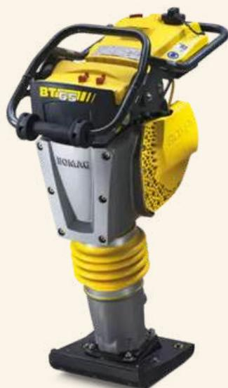
La BOMAG BT 65 est une pilonneuse compacte et puissante, idéale pour le compactage des tranchées, remblais et fondations. Équipée d'un moteur Honda GXR 120 de 2,8 kW, elle offre une force de frappe de 17 kN pour seulement 68 kg. Sa conception robuste, son système anti-vibrations et son excellente maniabilité garantissent confort d'utilisation, fiabilité et performance sur tous les chantiers..
