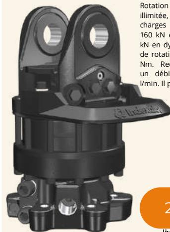
Rotation continue illimitée, conçu pour des charges axiales jusqu'à 160 kN en statique et 50 kN en dynamique. Couple de rotation élevé de 3300 Nm. Recommandé pour un débit d'huile de 35 l/min. Il pèse 64 Kg
