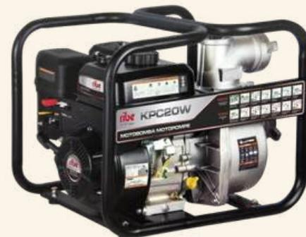
Motopompe à essence de sortie 3 pouces, équipée d'un moteur LS208 de 208 cm<sup>3</sup>, elle délivre un débit max de 60 m<sup>3</sup>/h, avec une hauteur de refoulement jusqu'à 28 m. Elle ne pèse que 29 kg.
