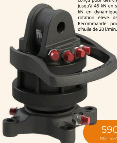
Rotation continue illimitée, conçu pour des charges axiales jusqu'à 45 kN en statique et 25 kN en dynamique. Couple de rotation élevé de 1100 Nm. Recommandé pour un débit d'huile de 20 l/min. Il pèse 29Kg
