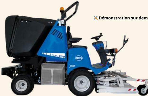
Machine hydrostatique polyvalente avec moteur diesel Yanmar 26 ch Stage V.
