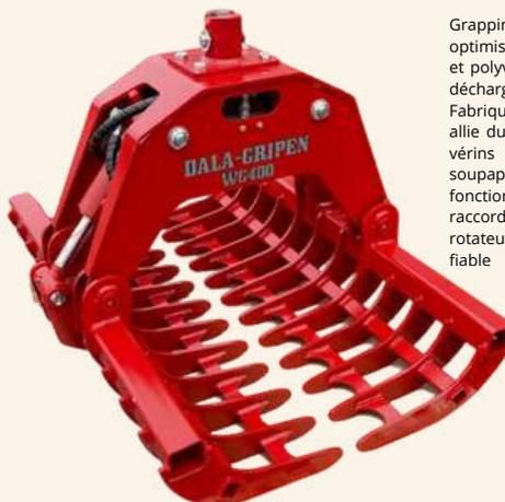
Grappin forestier innovant, conçu pour optimiser la manutention du bois. Léger, simple et polyvalent, il permet de charger, déplacer et décharger tous types de bois avec efficacité. Fabriqué en acier DOMEX haute résistance, il allie durabilité et poids réduit. Équipé de deux vérins hydrauliques synchronisés par une soupape de surpression, il assure un fonctionnement fluide et précis. Tous les raccords respectent les normes de montage des rotateurs, garantissant une intégration facile et fiable
