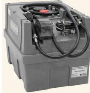
Cuve en polyéthylène rotomoulé, résistante aux UV, avec bouchon Ø 110 mm. Équipée d'une pompe auto-amorçante, pistolet automatique, tuyau de 4 m, alimentation 20V Li-ion. Passage de fourches et sangles pour transport facile. Autonomie ~500 L avec batterie 4 Ah. Livrée sans batterie.
