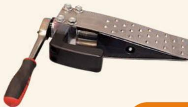
Hauteur de levage de 50 mm maximum, capacité de levage de 15t, poids de 1,6 Kg.
