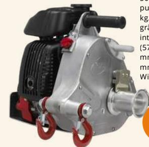
Moteur Honda 4 temps GXH-50 cc. Léger (16 kg) et puissant, il tire jusqu'à 1000 kg. Deux vitesses au choix grâce aux tambours interchangeables : 12 m/min (57 mm) ou 18 m/min\* (85 mm). Utilisable avec corde 12 mm et accessoires Portable Winch.
