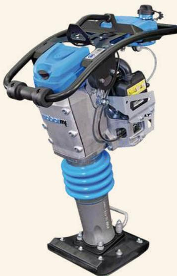
Pilonneuse à essence 4-temps (moteur Honda GXR120) d'environ 66-66 kg, conçue pour le compactage de sols sur chantier. Elle développe une force de frappe comprise entre 18 et 21 kN, avec un rythme d'environ 700 coups par minute. La largeur de résistance (semelle/ sabot) est d'environ 28 cm, ce qui lui permet de travailler efficacement sur des surfaces relativement larges tout en restant maniable.
