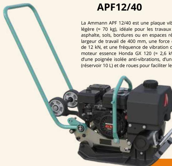
La Ammann APF 12/40 est une plaque vibrante marche-avant légère (≈ 70 kg), idéale pour les travaux de compactage sur asphalté, sols, bordures ou en espaces réduits. Elle offre une largeur de travail de 400 mm, une force centrifuge maximale de 12 kN, et une fréquence de vibration de 98 Hz. Dotée d'un moteur essence Honda GX 120 (≈ 2,6 kW), elle est équipée d'une poignée isolée anti-vibrations, d'un système d'arrosage (réservoir 10 L) et de roues pour faciliter le transport.
