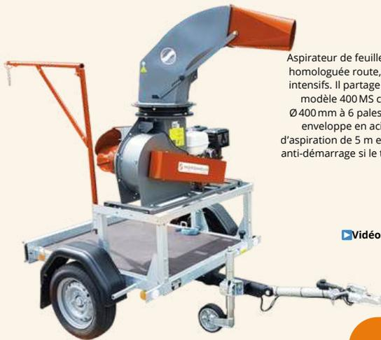
Aspirateur de feuilles monté sur remorque homologuée route, conçu pour les usages intensifs. Il partage les caractéristiques du modèle 400 MS classique : turbine de Ø 400 mm à 6 pales hautes performances, enveloppe en acier Creusabro, tuyau d'aspiration de 5 m en polyuréthane, sécurité anti-démarrage si le tuyau n'est pas connecté
