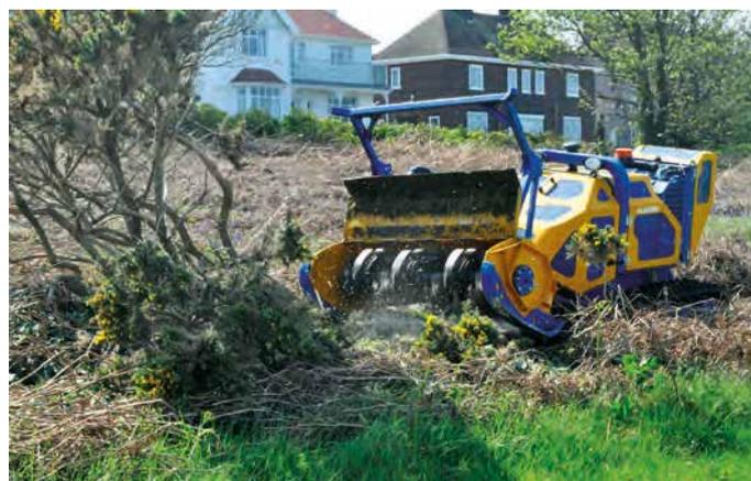
**GAMME DE BROyeurs** travaillant sur des pentes jusqu'à 55°.
