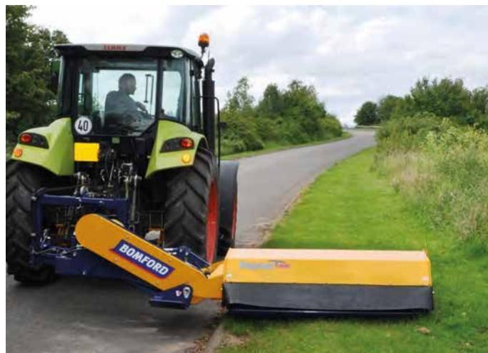
**GAMME DE FAUCHEUSES D'ACCOTEMENTS** composée de 5 modèles de 1,20 à 2,00 m de largeur de coupe, avec un montage arrière, ou frontal.
